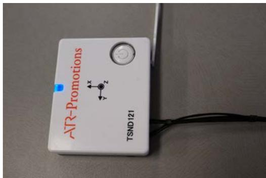
写真 3.ハウジングを TSND121 外部拡張端子に取り付け
