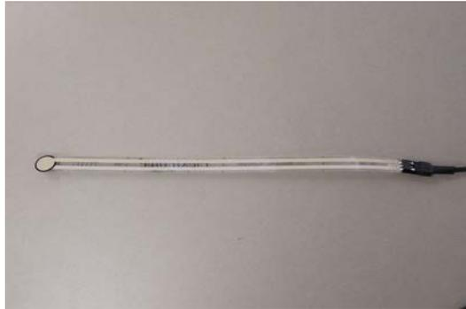
写真 2. 3P コネクタにフレキシフォースセンサを取り付け
